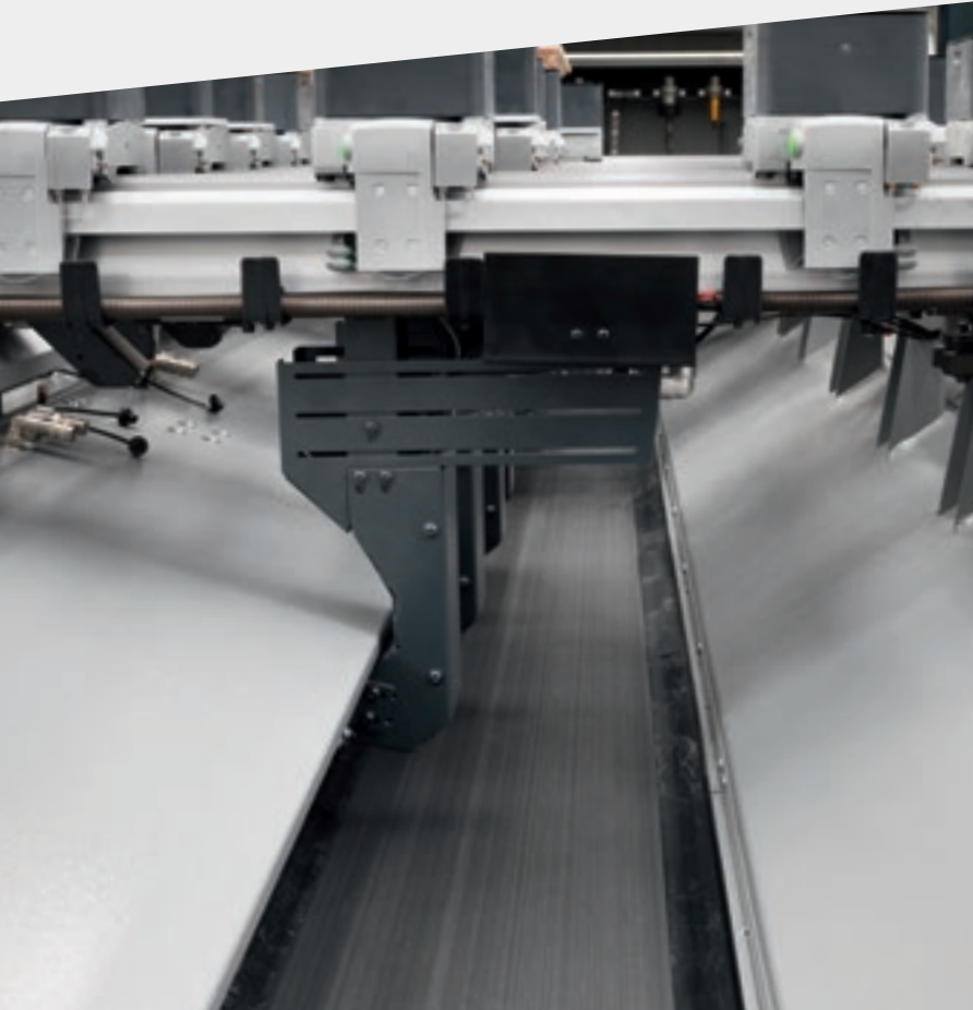
输送带用于运输屑和废料。
