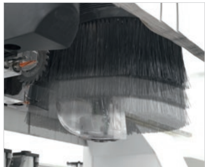
带8种不同设置的吸尘装置(4轴)和带12种不同设置(5轴)
