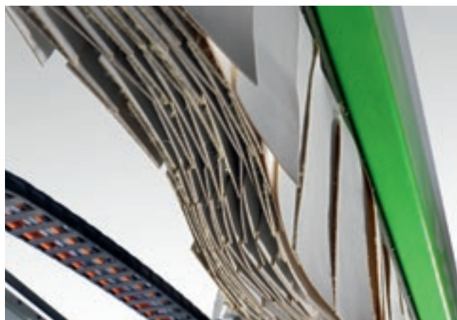
侧帘防护罩保护工作单元。
